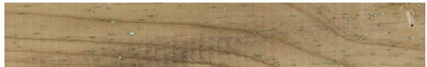
Verfahrensbedingt wird bei der Kesseldruckimprägnierung viel Wasser in das Holz gepresst. Besonders in der warmen Jahreszeit kann es bei frisch kesseldruckimprägnierten und somit feuchten Holz zu Schimmelbefall kommen. Dies ist jedoch nur oberflächig und beeinträchtigt die Qualität und Haltbarkeit des Holzes nicht. Mit einem Tuch oder einer Wurzelbürste können diese „Schönheitsfehler“ nach dem Trocknen des Holzes entfernt werden.
