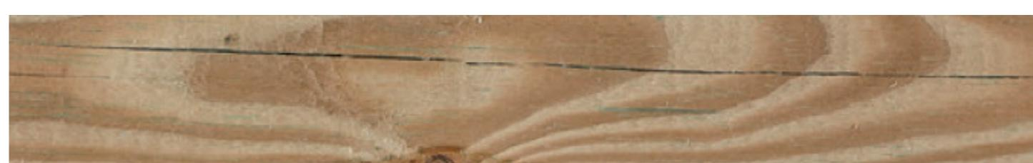
Holz ändert durch klimatische Einflüsse und die dadurch bedingte Aufnahme und Abgabe von Wasser seine Dimensionen. Dies ist eine natürliche Erscheinung des Werkstoffes Holz, kann daher von uns bei der Herstellung nicht ausgeschlossen werden und stellt keinen Mangel dar.
