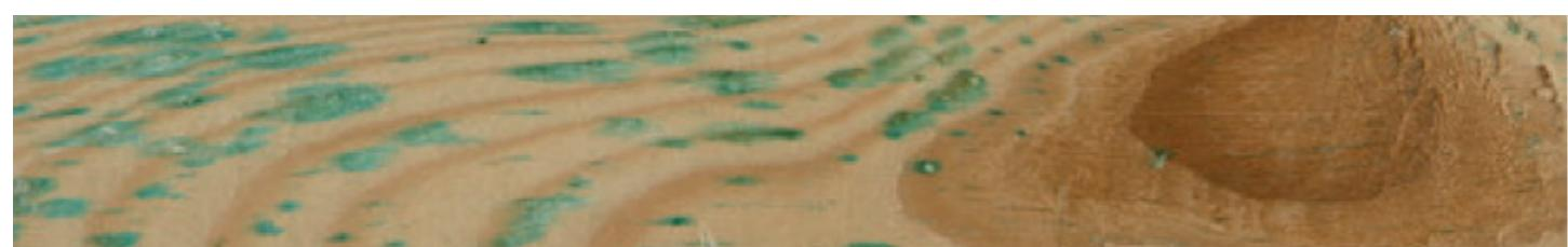
Bei der Kesseldruckimprägnierung werden zum Schutz der Holzoberfläche Salze in das Holz gepresst. Diese Imprägniersalze reagieren mit Holzinhaltsstoffen und können an einigen Stellen „ausblühen“. Diese ungefährlichen, grünlichen Salzkristalle verblassem im Laufe der Zeit.
